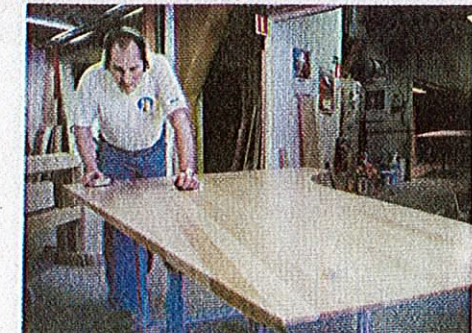
Anders Andersson slipar en bänkskiva i lönn som ska finnas på våning två i det nya Sverigehuset i Washington.
